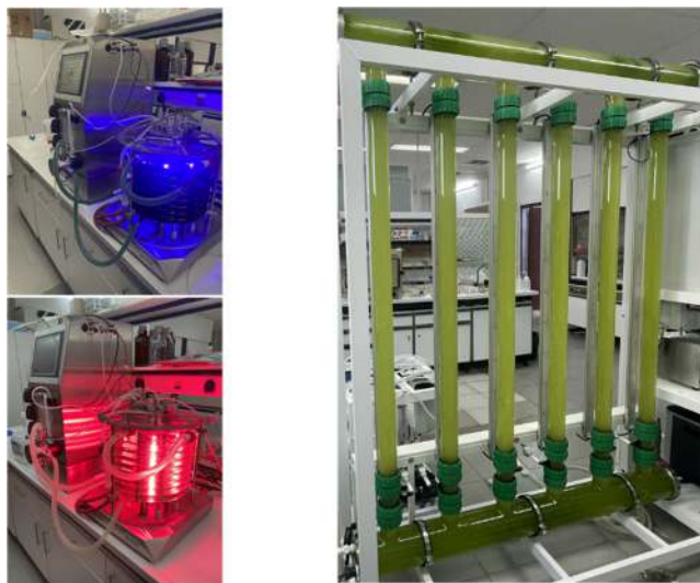
Σχήμα 2: Συστήματα καλλιέργειας μικροφυκών: εργαστηριακής κλίμακας οριζόντιος αυλωτός φωτοβιοαντιδραστήρας (PBR) ανακυκλοφορίας (7 L - αριστερά) και πιλοτικής κλίμακας κάθετος αυλωτός PBR ανύψωσης αέρα (70 L - δεξιά).
